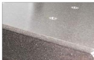
**Монолитный, не подверженный тепловому расширению стол из полимербетона с конусными направляющими.**
