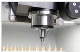
**2 кВт шпиндель и система микрораспыления СОЖ для идеального реза без заусенцев**
