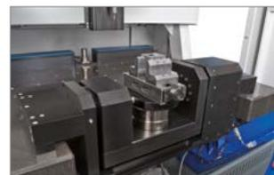
**5-осевое фрезерование** с применением наклонно-поворотного стола для точной комплексной обработки сложных деталей (опционально).
