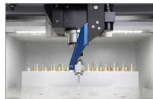
**Контактная измерительная 3D головка (XYZ-датчик) и камера для простого базирования**
