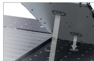
**Электрически переключаемая вакуумная оснастка** обеспечивает очень гибкую и эффективную работу благодаря быстрой переналадке.
