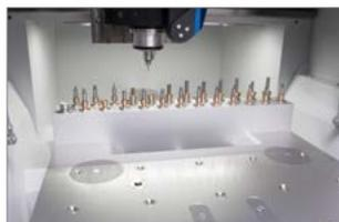
**24-позиционный инструментальный магазин с встроенным датчиком длины для максимальной гибкости и точности**
