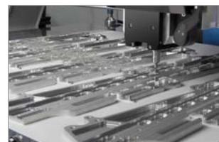
**Большая рабочая поверхность идеальна для многоместной обработки деталей.**
